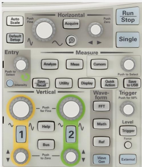
圖 2：示波器前面板上的旋鈕應包括全部關鍵設定變數的旋鈕。
