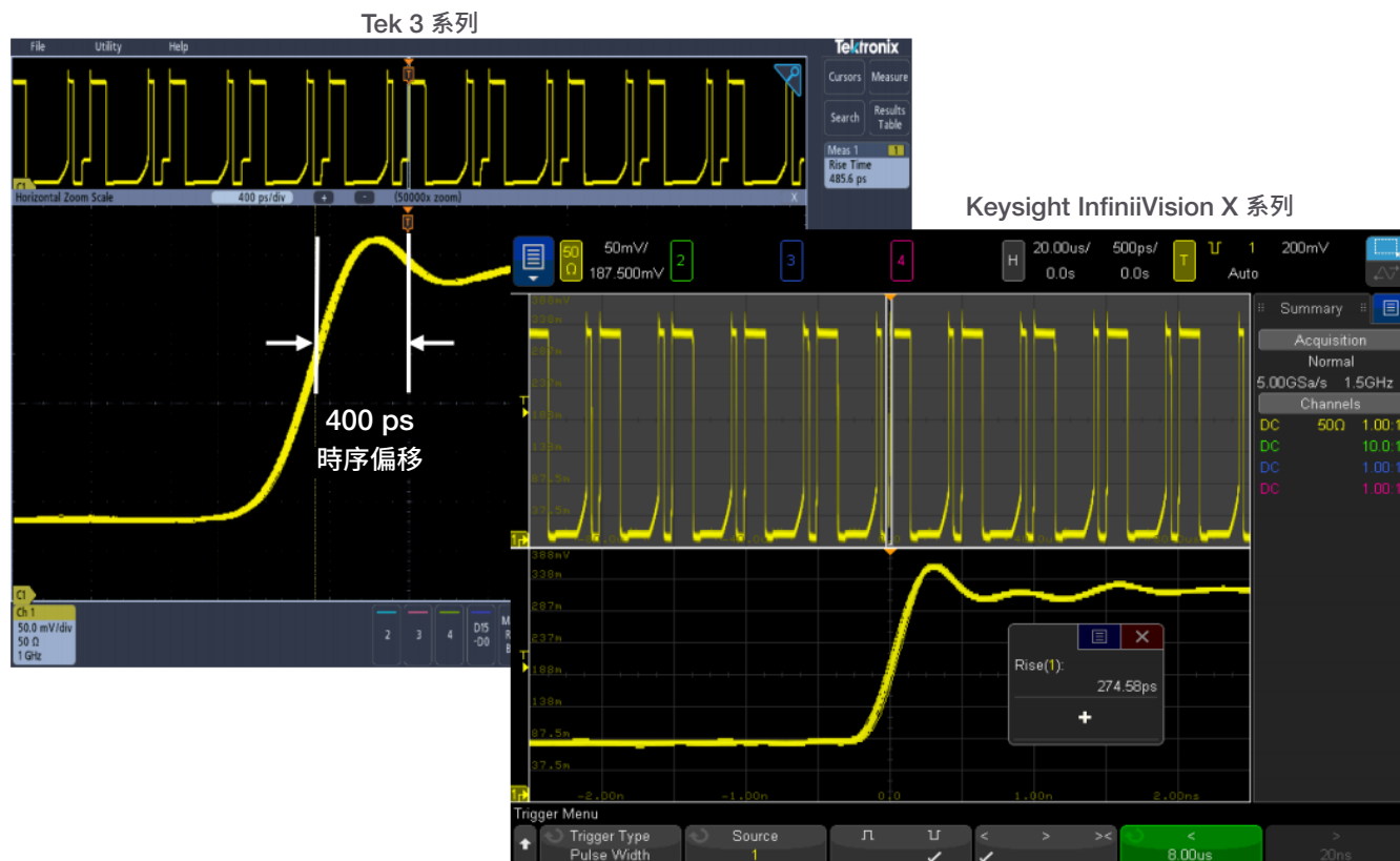
圖 6：使用進階參數觸發時，Tek 3 系列會將觸發點放在指定觸發點（螢幕中央）之前 400 ps 的位置，InfiniiVision 示波器則會將觸發點準確地放在螢幕中央
