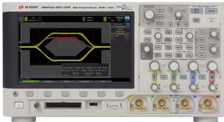
圖10：波罩測試讓擷取一長時間段內的錯誤變得更輕鬆
