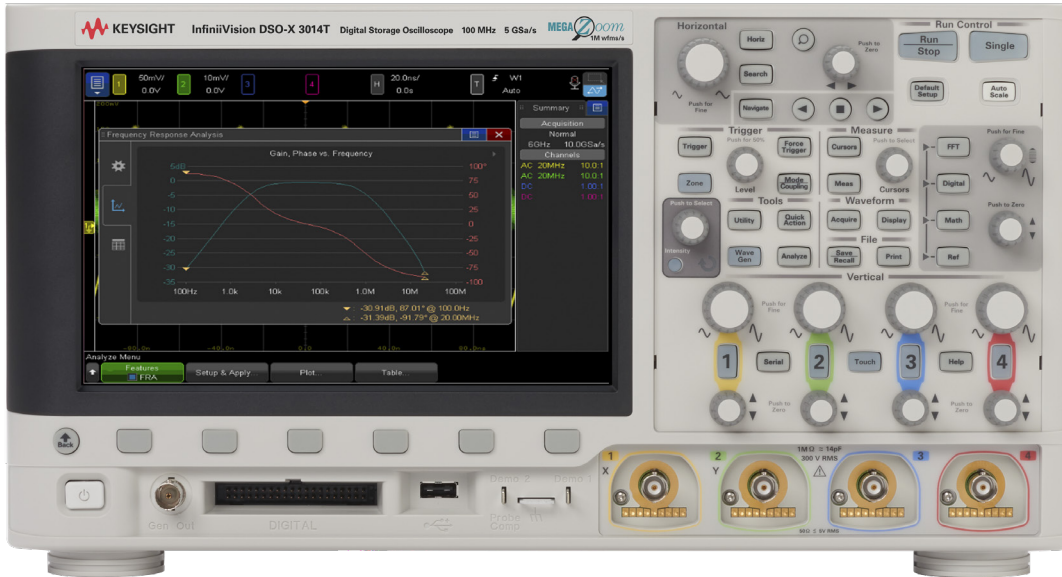
圖 13：產生的波特圖能顯示增益與相位及頻率資料
