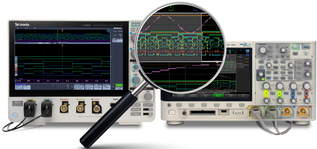
圖 14：InfiniiVision 示波器螢幕上的紫色軌跡為邏輯匯流排圖表繪製功能所產生的結果；Tektronix 3 系列示波器則無法繪製邏輯匯流排圖表
