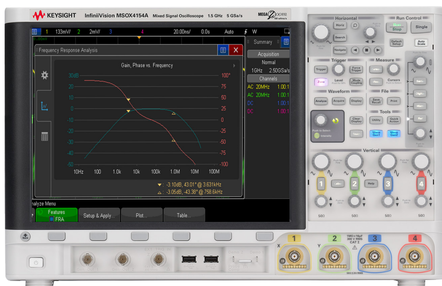
圖 6：使用 InfiniiVision 示波器對振幅和相位進行頻率響應分析
