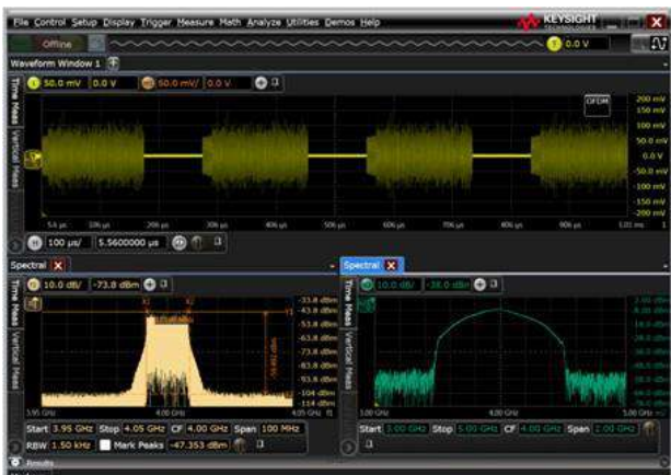
使用 Infiniium 擷取並分析雷達叢發信號，如圖中 OFDM 的例子。
