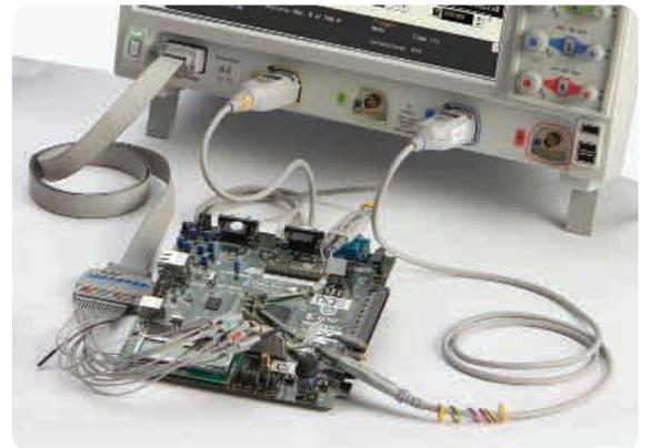
您要使用 Altera 或 Xilinx 的 FPGA 來進行設計嗎？使用 FPGA 動態探棒，可以快速地執行 FPGA 內部信號的量測。您要使用 I<sup>2</sup>C、SPI、RS-232、或低速或全速 USB 嗎？請使用數位通道來擷取並解碼這些匯流排，保留類比通道來執行其他的時序關聯量測。
